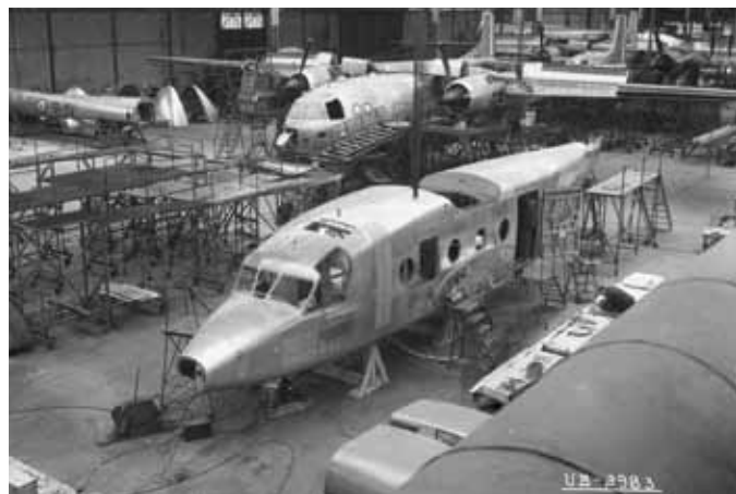
Bâtiment 8 : chaîne de montage du Nord 262 ; à l'arrière-plan, chaîne de réparation du Noratlas, 6 janvier 1962 (AD Cher - Fonds MBDA France - Fonds I 17J).
