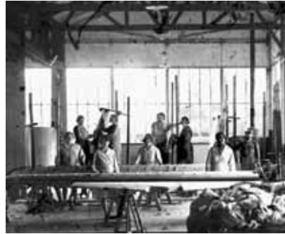
Atelier d'entoilage des LH 431, début des années 30 (AD Cher - Fonds MBDA France - Fonds 117)).
